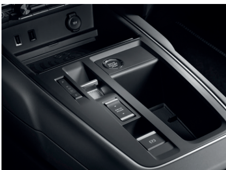
Převodovka 8- EAT8 s režimem « BRAKE », pro účinnější dobíjení
